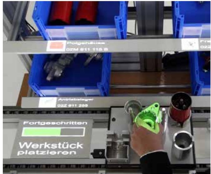
Abb. 10: Ein Arbeitsplatz benutzt AlaaS um projiziertes Montagefeedback zur Werkerassistenz einzublenden
