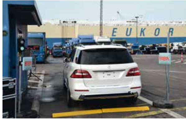
Praxistests des mobilen RFID-Gates an der Schiffsentladung
