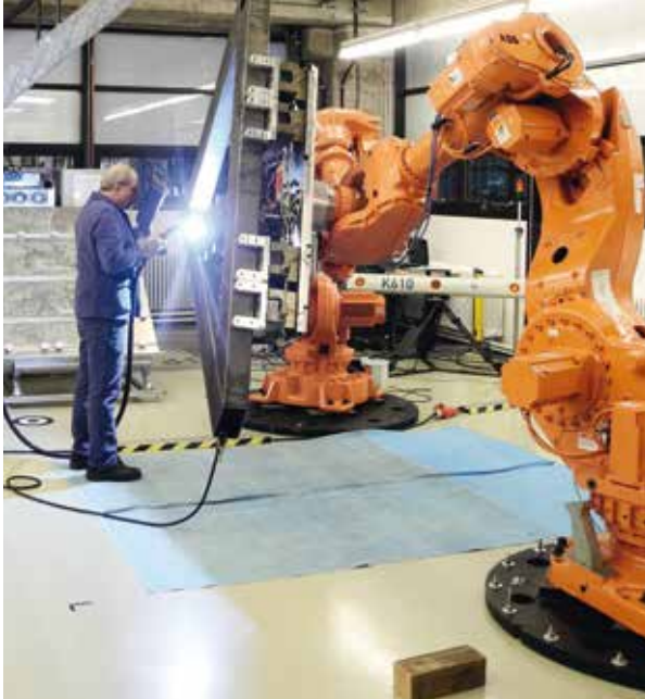
Der Roboter unterstützt den Schweißer bei seiner Arbeit
