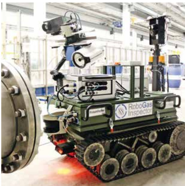
Der RoboGasInspector soll Lecks in Gasleitungen selbstständig detektieren.
