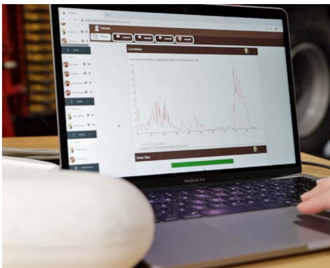
Ansicht des Prototyps der nPotato: Im Hintergrund erkennbar sind die erfassten Stöße und Rotationen.
