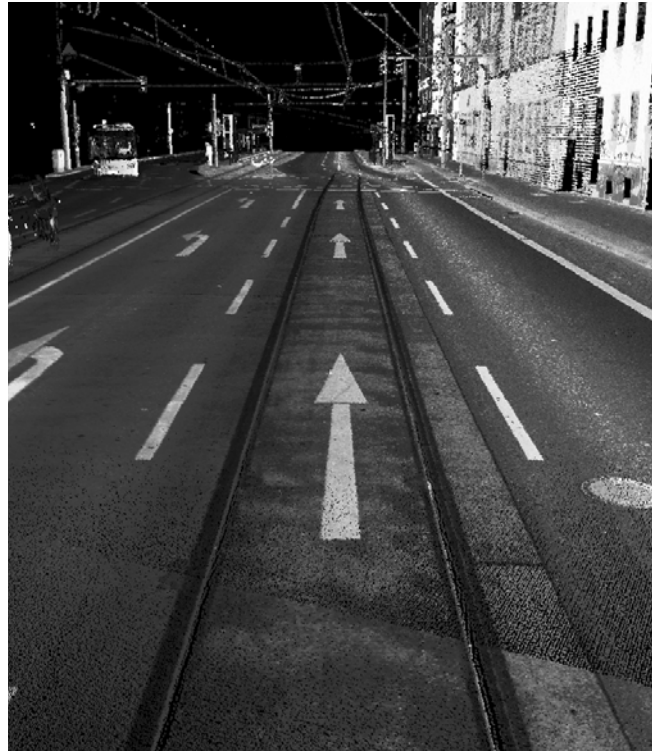
Modell einer vermessenen Teststrecke in Berlin: linke Spur: glatte Straße, keine Unebenheiten; mittlere Spur: Schienen, Querwellen; rechte Spur: Kanaldeckel und Einstiegsschacht, Längswelle in der Mitte der Spur.
