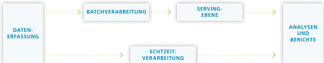
Abbildung 1: Aufbau der Lambda-Architektur (Quelle: seele, O. Zichert)
