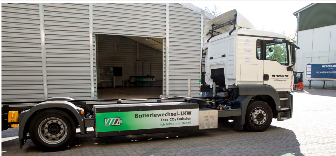
Abbildung 8: Projekt RouteCharge / Batteriewechsel-LKW (IKT für Elektromobilität / Hornischer GbR)
