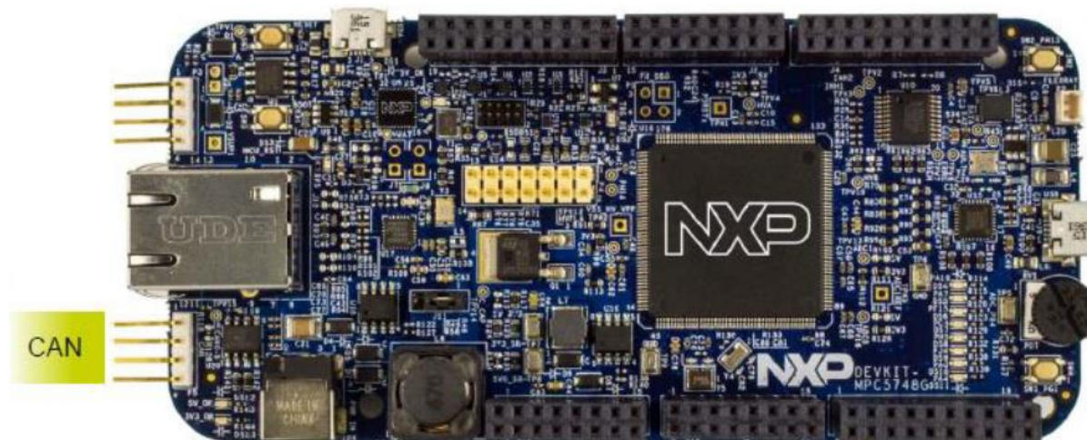
Abbildung 12: CAN-Ethernet Bridge – basierend auf MPC5748G
