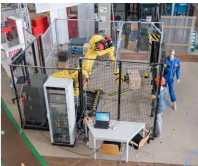
Abbildung 4: Mensch-Roboter-Kooperation mit dem INSA-Sicherheitskonzept (Quelle: www.insa-projekt.de )
